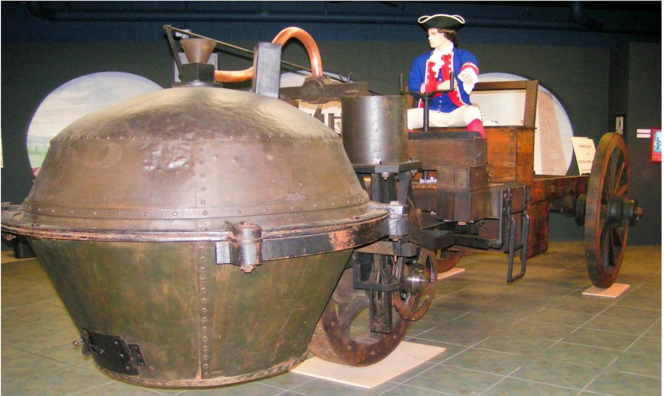
Las primeras demostraciones del carro de Cugnot se hicieron a solo 5 kilómetros hora, y acabaron con el invento estrellado contra un muro, produciendo así el primer accidente automovilístico de la historia.
